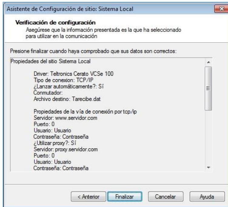
Figura 3.38 Configurando la conexión a Teltronics Cerato
