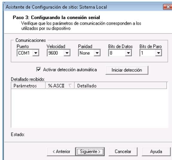
Figura 3.8 Configurando la conexión serial
