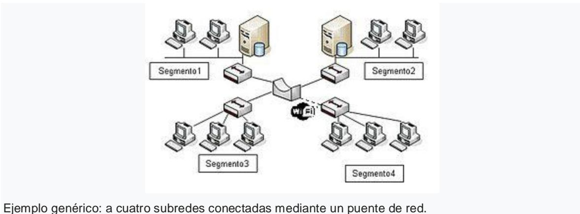
Ejemplo genérico: a cuatro subredes conectadas mediante un puente de red.
