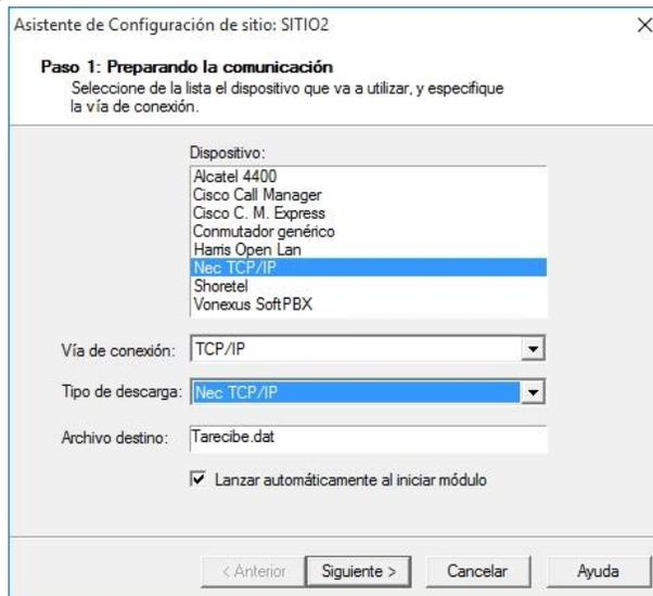
Figura 3.30 Configurando la conexión a NEC IP
