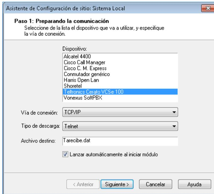
Figura 3.36 Configurando la conexión a Telnetrics Cerato
