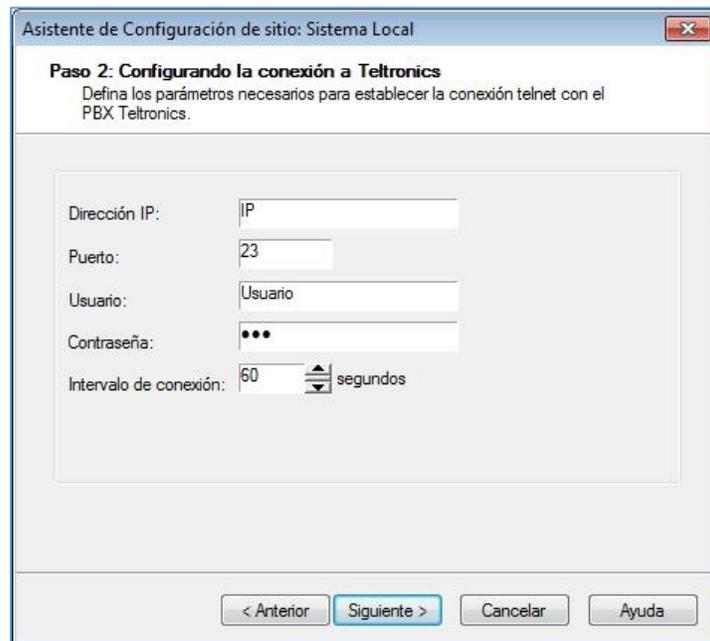
Figura 3.37 Configurando la conexión a Telnetrics Cerato
