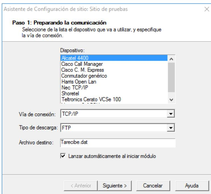
Figura 3.15 Preparando la comunicación para una conexión TCP/IP
