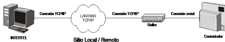
Figura 3.3 Conexión TCP/IP con Buffer Hardware
