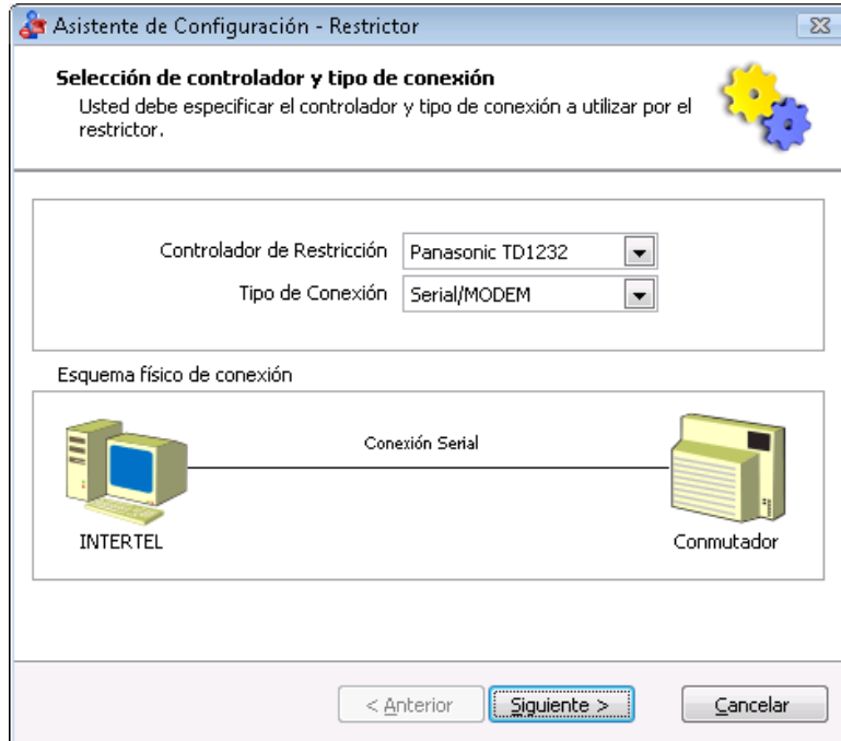
Figura 15.6. Selección de controlador y tipo de conexión serial/modem
