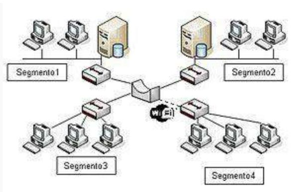
Ejemplo genérico: a cuatro subredes conectadas mediante un puente de red.
