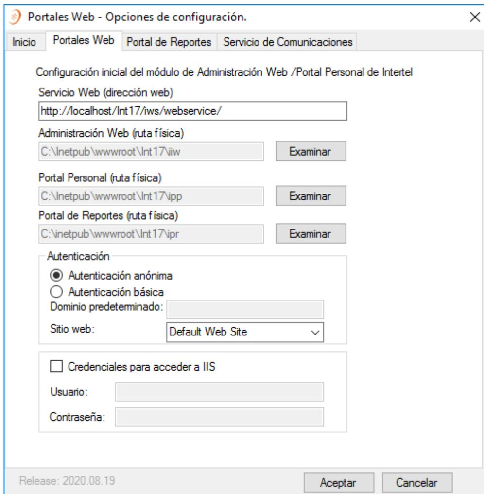
Figura 2.59 Configuración de ruta física del servicio web.
