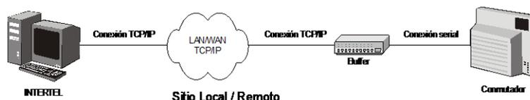
Figura 3.3 Conexión TCP/IP con Buffer Hardware
