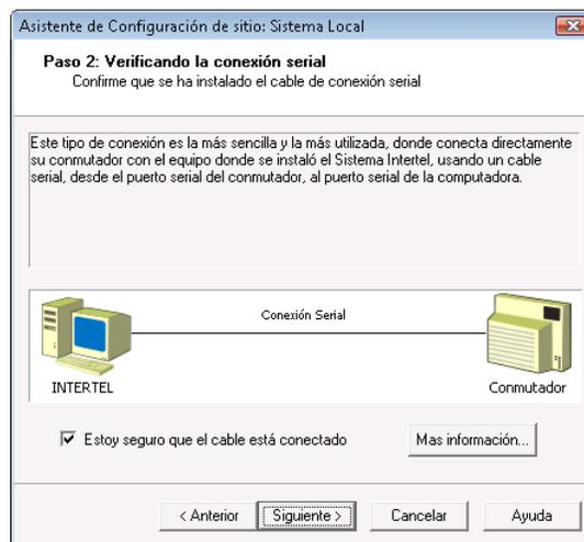
Figura 3.7 Verificando la conexión serial
