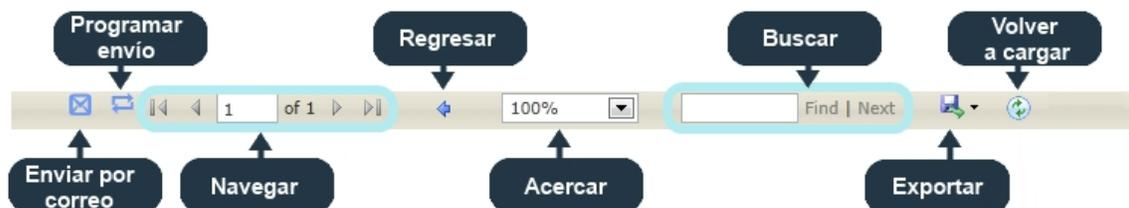
Figura 3.5. Funciones incluidas en la barra de herramientas de un reporte
